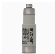
**Cartouche fusible, Basse tension, 10 A, AC 400 V, 50 kA, D01, gR, IEC, ultra-rapide**
