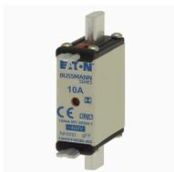
**Cartouche fusible, Basse tension, 10 A, AC 400 V, 120 kA, NH000, gFF, IEC, à double indicateur de fusion, pattes d'extraction isolées**
