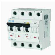
Disjoncteur différentiel, 6 A, 300 mA, caractéristique disjoncteur modulaire (MCB) : D, 3p+N, caractéristique bloc différentiel (RCD) : AC
