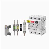
**Cartouche fusible, grande vitesse, 40 A, DC 4000 V, 60 kA, compact size 1, 57 x 70 x 414 mm, aR, IEC, indicateur de type K**
