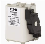
**Cartouche fusible, grande vitesse, 315 A, AC 1400 V, 100 kA, size 1, aR, IEC, indicateur de type K**
