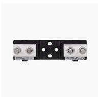
**Socle pour fusible, grande vitesse, 400 A, AC 1000 V, DIN 00, DIN 000, DIN, IEC, socle de fusible centré fixe (80 mm)**
