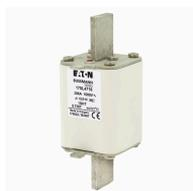
**Cartouche fusible, grande vitesse, 200 A, AC 1000 V, size 1, 53 x 53 x 135 mm, aR, IEC, indicateur de type T, pattes d'extraction conductrices**
