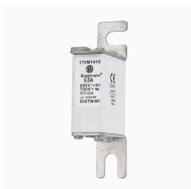
**Cartouche fusible, grande vitesse, 63 A, AC 690 V, 200 kA, DIN 000, gR, DIN, IEC, indicateur de type T, corps carré avec pattes décalées à fixation par boulon (fendues)**
