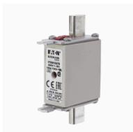
**Cartouche fusible, grande vitesse, 100 A, AC 690 V, 200 kA, DIN 000, aR, DIN, IEC, indicateur de type T, corps carré avec contacts à couteaux**
