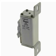
**Cartouche fusible, grande vitesse, 100 A, DC 1200 V, 50 kA, compact size 1, 39 x 66 x 164 mm, aR, IEC, indicateur de type K**
