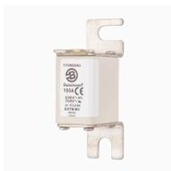
**Cartouche fusible, grande vitesse, 100 A, AC 690 V, 200 kA, DIN 00, aR, DIN, IEC, indicateur de type T, pattes d'extraction conductrices**
