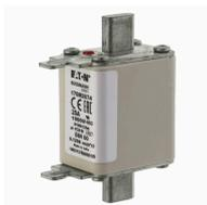
**Cartouche fusible, grande vitesse, 25 A, AC 1000 V, 125 kA, DIN 00, aR, DIN, IEC, indicateur de type T, pattes d'extraction conductrices**
