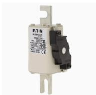
**Cartouche fusible, 80 A, AC 1250 V, 100 kA, compact size 1, 45 x 58 x 138 mm, aR, DIN, IEC, indicateur de type K**
