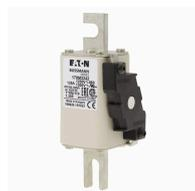
**Cartouche fusible, grande vitesse, 125 A, AC 1250 V, 100 kA, compact size 1, 45 x 58 x 138 mm, aR, DIN, IEC, indicateur de type K**
