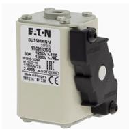
**Cartouche fusible, grande vitesse, 80 A, AC 1250 V, 100 kA, compact size 1, 45 x 59 x 75 mm, aR, IEC, UL, indicateur de type K**
