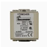
**Cartouche fusible, grande vitesse, 40 A, AC 690 V, compact size 1, 45 x 45 x 140 mm, aR, UL, IEC, M8, corps carré avec contacts affleurants**
