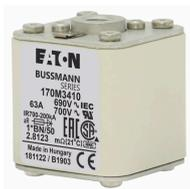
**Cartouche fusible, grande vitesse, 63 A, AC 690 V, compact size 1, 45 x 59 x 51 mm, aR, IEC, UL, M8, corps carré avec contacts affleurants**
