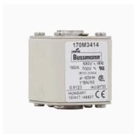
**Cartouche fusible, grande vitesse, 160 A, AC 690 V, 200 kA, compact size 1, 45 x 59 x 51 mm, aR, IEC, UL, indicateur de fusion simple**
