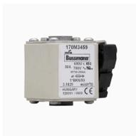
Cartouche fusible, grande vitesse, 50 A, AC 690 V, 200 kA, compact size 1, 45 x 59 x 51 mm, aR, IEC, UL, indicateur de type K
