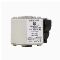
**Cartouche fusible, grande vitesse, 63 A, AC 690 V, 200 kA, compact size 1, 45 x 59 x 51 mm, aR, IEC, UL, indicateur de type K**
