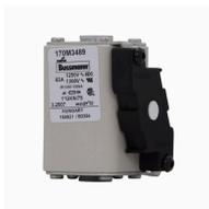
**Cartouche fusible, grande vitesse, 63 A, AC 1250 V, 100 kA, compact size 1, 45 x 59 x 81 mm, aR, IEC, UL, corps carré avec contacts affleurants**
