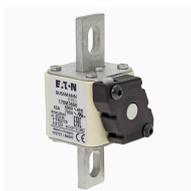
**Cartouche fusible, grande vitesse, 63 A, AC 690 V, 200 kA, compact size 1, 45 x 59 x 110 mm, aR, IEC, UL, indicateur de type K, modèle nord-américain**
