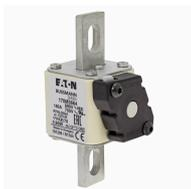
**Cartouche fusible, grande vitesse, 160 A, AC 690 V, 200 kA, compact size 1, 45 x 59 x 110 mm, aR, IEC, UL, indicateur de type K, modèle nord-américain**
