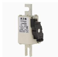
**Cartouche fusible, grande vitesse, 50 A, AC 1000 V, compact DIN 1, 43 x 61 x 138 mm, aR, DIN, IEC, indicateur de type K**
