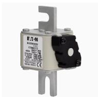
Cartouche fusible, grande vitesse, 450 A, AC 690 V, 200 kA, DIN 1, 53 x 69 x 108 mm, aR, DIN, IEC, indicateur de type K
