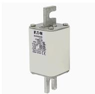
**Cartouche fusible, 200 A, AC 1250 V, 100 kA, size 1, 53 x 66 x 138 mm, aR, DIN, IEC, indicateur de fusion simple**
