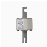
**Cartouche fusible, grande vitesse, 450 A, AC 690 V, 200 kA, DIN 1, 53 x 66 x 138 mm, aR, DIN, IEC, indicateur de fusion simple**
