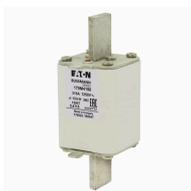
**Cartouche fusible, 315 A, AC 1250 V, 100 kA, size 1, 53 x 63 x 135 mm, aR, IEC, indicateur de type T, pattes d'extraction conductrices**
