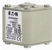
**Cartouche fusible, grande vitesse, 350 A, AC 690 V, size 1, 53 x 69 x 51 mm, aR, IEC, UL, filetage US, corps carré avec contacts affleurants**
