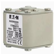
Cartouche fusible, grande vitesse, 550 A, AC 690 V, size 1, 53 x 69 x 51 mm, aR, UL, IEC, 18 UNC, corps carré avec contacts affleurants
