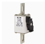
**Cartouche fusible, grande vitesse, 315 A, AC 1000 V, size 1, 51 x 68 x 102 mm, aR, IEC, indicateur de fusion simple**
