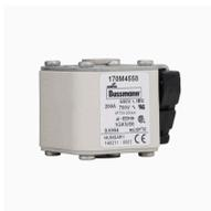
Cartouche fusible, grande vitesse, 200 A, AC 690 V, size 1, 53 x 69 x 51 mm, aR, IEC, indicateur de fusion simple
