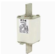
Cartouche fusible, 450 A, AC 1250 V, 100 kA, size 1, 53 x 63 x 135 mm, aR, IEC, indicateur de type T, pattes d'extraction conductrices
