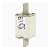
**Cartouche fusible, grande vitesse, 100 A, AC 1250 V, 100 kA, size 1, 53 x 63 x 135 mm, aR, IEC, indicateur de type T, pattes d'extraction conductrices**
