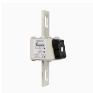
Cartouche fusible, grande vitesse, 450 A, AC 690 V, 200 kA, size 1, 53 x 69 x 136 mm, aR, IEC, UL, indicateur de type K, modèle nord-américain
