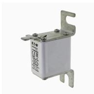
**Cartouche fusible, grande vitesse, 40 A, AC 1000 V, 125 kA, size 00, 30 x 47 x 98 mm, aR, DIN, IEC, indicateur de type T**
