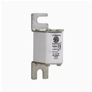
**Cartouche fusible, grande vitesse, 100 A, AC 1000 V, 125 kA, size 00, 30 x 47 x 98 mm, aR, DIN, IEC, indicateur de type T**
