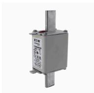
**Cartouche fusible, grande vitesse, 450 A, AC 690 V, 200 kA, DIN 1, aR, DIN, IEC, indicateur de type T, pattes d'extraction conductrices**
