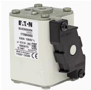
**Cartouche fusible, grande vitesse, 160 A, AC 1000 V, 125 kA, DIN 1, 51 x 69 x 138 mm, aR, DIN, IEC, indicateur de type K**
