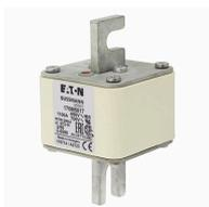
**Cartouche fusible, grande vitesse, 1100 A, AC 600 V, 200 kA, DIN 2, 61 x 61 x 108 mm, aR, DIN, IEC, indicateur de fusion simple, entraxes de fixation 80 mm**
