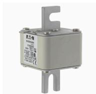
Cartouche fusible, grande vitesse, 630 A, AC 690 V, 200 kA, DIN 2, 61 x 75 x 108 mm, aR, DIN, IEC, indicateur de type T
