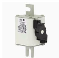
Cartouche fusible, grande vitesse, 315 A, AC 1250 V, 100 kA, size 2, 61 x 77 x 138 mm, aR, DIN, IEC, indicateur de type K
