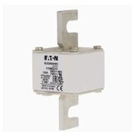
**Cartouche fusible, grande vitesse, 550 A, AC 690 V, size 2, 61 x 61 x 126 mm, aR, IEC, indicateur de fusion simple**
