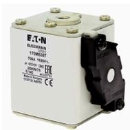
Cartouche fusible, grande vitesse, 700 A, AC 1000 V, 100 kA, size 2, 61 x 75 x 77 mm, aR, IEC, UL, indicateur de type K
