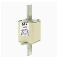
**Cartouche fusible, grande vitesse, 200 A, AC 690 V, 200 kA, compact DIN 2, 55 x 71 x 150 mm, aR, DIN, IEC, indicateur de fusion simple, pattes d'extraction conductrices**
