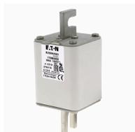
**Cartouche fusible, grande vitesse, 500 A, AC 3000 V, size 3, 75 x 96 x 298 mm, aR, IEC, indicateur de fusion simple**
