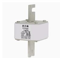
**Cartouche fusible, grande vitesse, 1250 A, AC 690 V, 200 kA, DIN 3, 76 x 90 x 139 mm, aR, DIN, IEC, indicateur de fusion simple**
