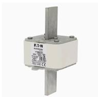
Cartouche fusible, grande vitesse, 400 A, AC 1250 V, 100 kA, size 3, 76 x 76 x 155 mm, aR, IEC, indicateur de type T, pattes d'extraction conductrices
