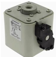
**Cartouche fusible, grande vitesse, 900 A, AC 1250 V, size 3, 76 x 92 x 91 mm, aR, UL, IEC, 13 UNC, corps carré avec contacts affleurants**
