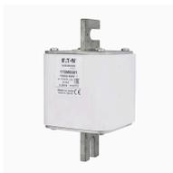
**Cartouche fusible, grande vitesse, 1500 A, AC 800 V, 125 kA, size 3, 76 x 90 x 141 mm, aR, IEC, indicateur de fusion simple**
